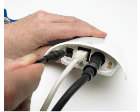
Koppla in nätadaptern i anslutningskontakten märkt X1.
