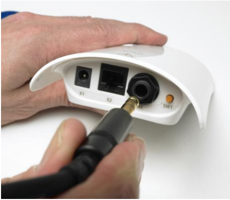
Koppla in sensorns kabelplugg till kontrollenhetens X3-märkta anslutningskontakt.
