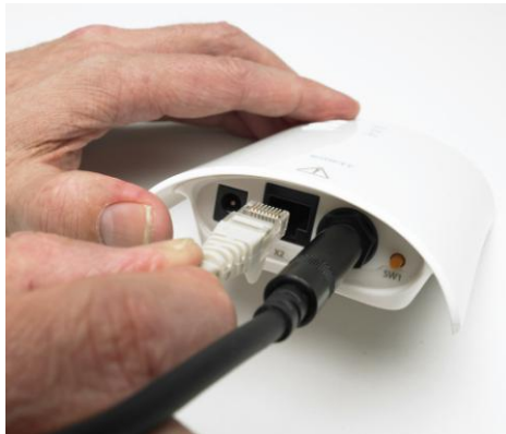
Vid en sammankoppling mellan reläutgången och ett annat system, anslut passande kabel till X2-märkta anslutningskontakt.
