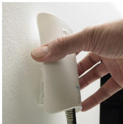
Fäst kontrollenheten vid monteringen uppifrån och låt den glida ner över väggmonteringen.
